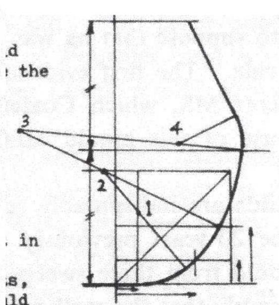
ベイカーは図 21.に「このやり方でヴェネチア人達は今から20年前までは4個の(弧)の中心が有る型板を作っていた。今日では3個を用いる」と注意書きを付している。この注意書きのように、その後の英国では主に3個の弧が最大横断面の曲線(スィープ)に使われた。ただし、タンブル・ホーム用の船の内側に向けてのトップ・チンバーの曲線(図 25.「ホロ
