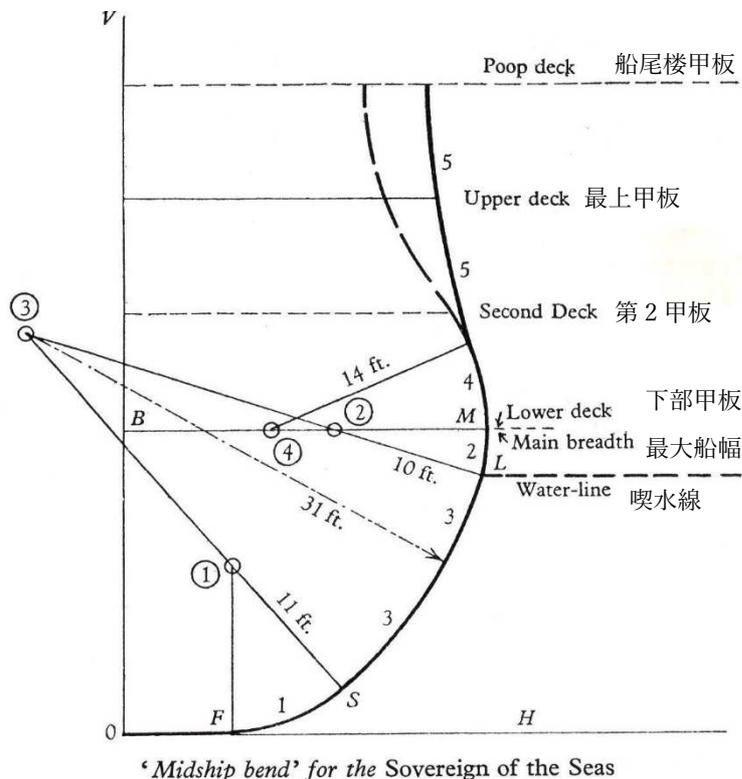
この最大横断面は①から④を円の中心とする弧の4本の曲線（スweep）とタンブル・ホームの船の内側への凹型（ホロウイング）の曲線（実線が採用案、破線は代案）から成り立っている。この横断面は次のような手順で描かれた：
