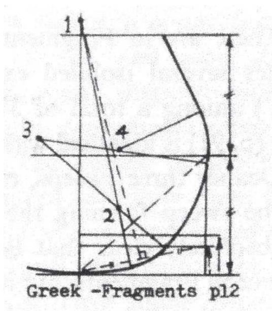
図 21. 「船大工術の断片」のヴェネチア船の横断面(R.バーカーによる)
