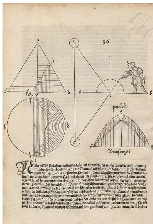
ベイカーはデューラーの「技芸の知的性質, Underweysung der Messung」(ラテン語版)を読んでおり、「船大工術の断片」(26ページ)の中で、「アルバルツス・デュレリ(デューラーのラテン語名)が彼の幾何学の本の中で見せている(デモンストレート)のを私が見つけた或る縮尺目盛(スケール)」を使っている」と述べ、数学を理解する者がいない当時の造船所の中では、ベイカーは数学よりも「幾何学のデモンストレーション」をする方が現実的であると考えたのである。
