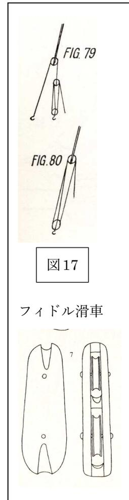
6. ガーネット。3本のロープと、3個の滑車を有している。同じ名前のテークルが在る(訳注：ガーネット・テークルのこと。訳注⑰2)アンダーソン、57p参照)。ペンダントが、檣楼縦材によって
