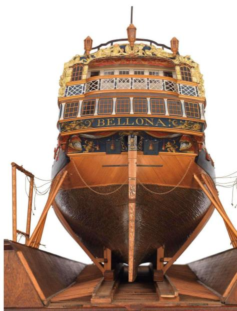
構造を有しており(英国の造船所について書かれたテキストの記述の全てと違っている)、長さ方向の行止支柱(複)を伴う垂直の支柱(複)であり、ストップピング・アップではない。他の知られた方法(Fig.17)との混合物である。明らかにそれは完全な構造ではない(横断する結び綱あるいは突っ張り支柱が無いし、行止支柱板(複)も無いが、船の模型を伴った当時の傾斜船台なのであろうか。もし、そうであるとすると、上記の年代表とは合わない。このお話(yarn)は完全ではない。
