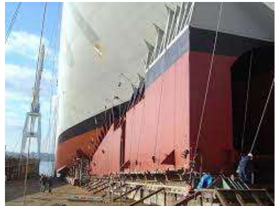
図 11 作業員による砂箱の操作
