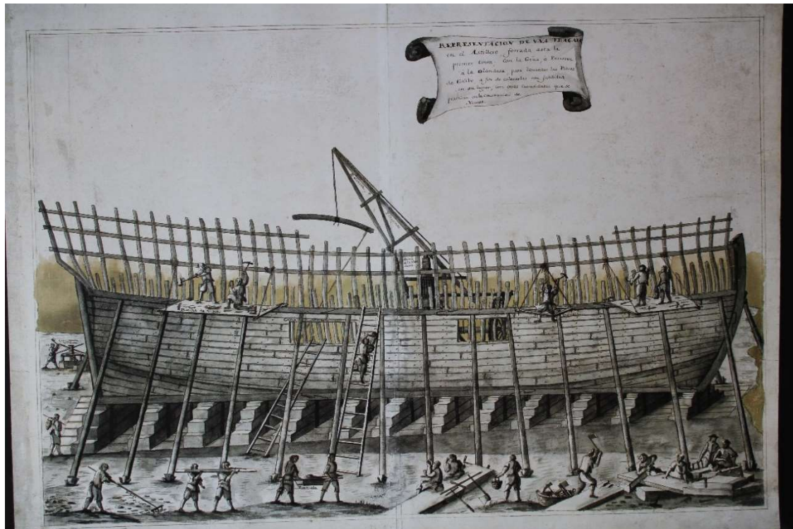
訳者挿入付録図4 船台で建造中のナビオ船、オランダ式クレーンの使用 「ビクトリア公爵のアルバム」の第17葉、マドリード海軍博物館
