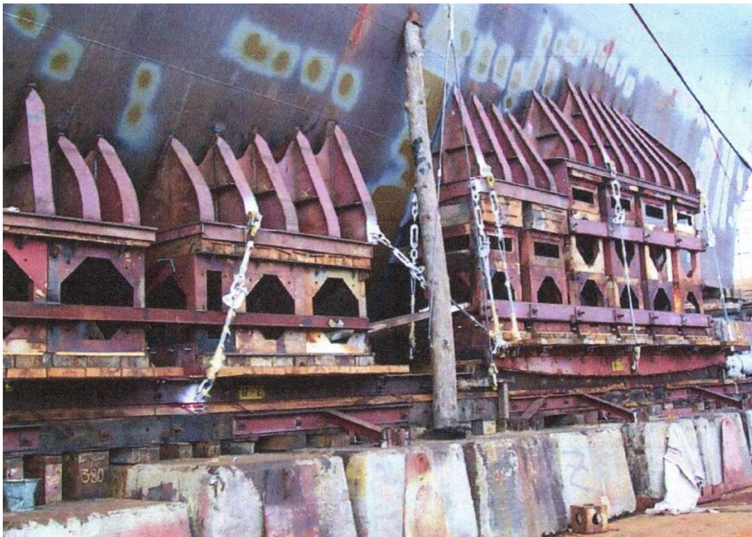
図 8 船首の進水台 イマーダ (複)、滑走台 アンギーラ (複)及びポベット サント (複)
