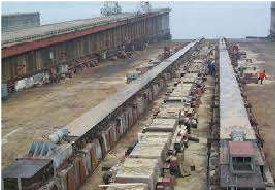
カーマ・デ・ランサミエント 図4 進水の寝台
