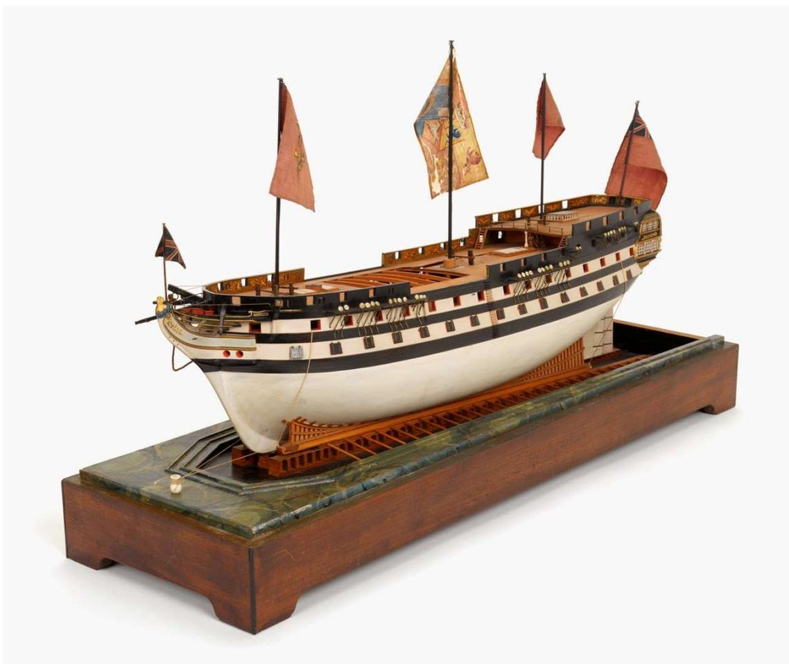
この素晴らしい1815年頃の英国の74門砲艦の模型は進水の準備が整っていることを見せられている。地上船台(複)、滑走板(複)、船腹船台(複)、そしてクレードルが船殻の下に明瞭に見てとれる。滑走板(複)から横側へ(sideways)突き出ている材木の支柱は、英国のやり方を反映しており、船が滑走板(複)から横側へ動かないように保つ意味があった。
