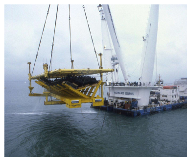
トグ・モール号による ジャッキの付いた船架 の吊り上げ
