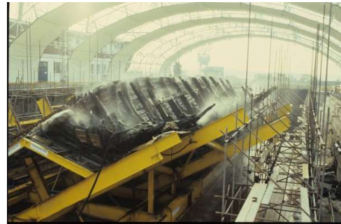
ホット・ボックス内で冷水の散布、この過程で、60 度傾いていた船体を旋回させて直立させた。
