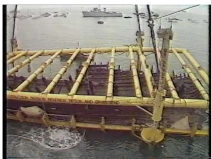
トグ・モール号による ジャッキの付いた船架 の吊り上げ
