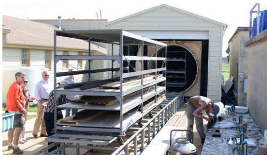
フリーズ・ドライ設備への部材の挿入
