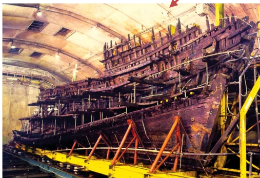
ホット・ボックス内で PEG 散布を開始する直前の状態
