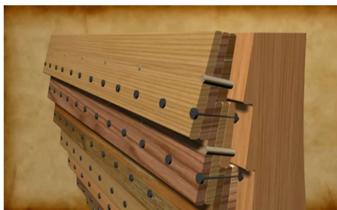
図 16：グレース・ディウ号の 3 枚板を重ねて 1 条の船側板張りとした模型
