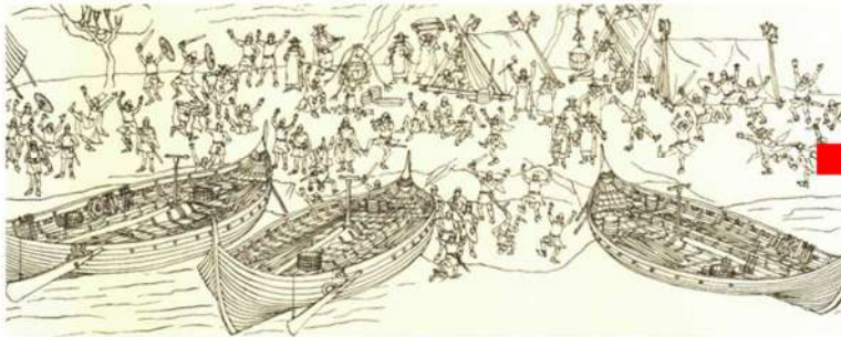
クリンカー・ビルト 鎧張り造りの中世のバイキング船
