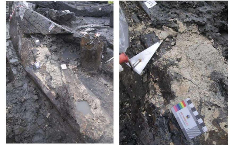
Fig. 12 - Revestimento de argamassa esbranquiçada que poderá corresponder a gala-gala, colocado entre o forro exterior e o sobrecostado do navio Boa Vista 2.
